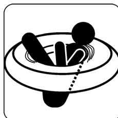
Figura 2 — Riesgo de quedar atrapado si el tamaño no es el adecuado
